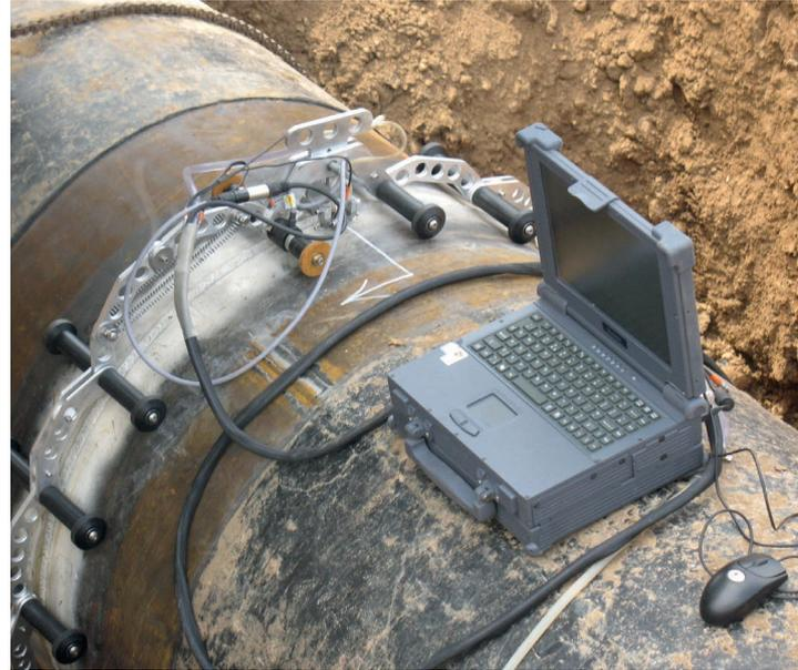
TOFD an einer Pipelineschweißnaht
