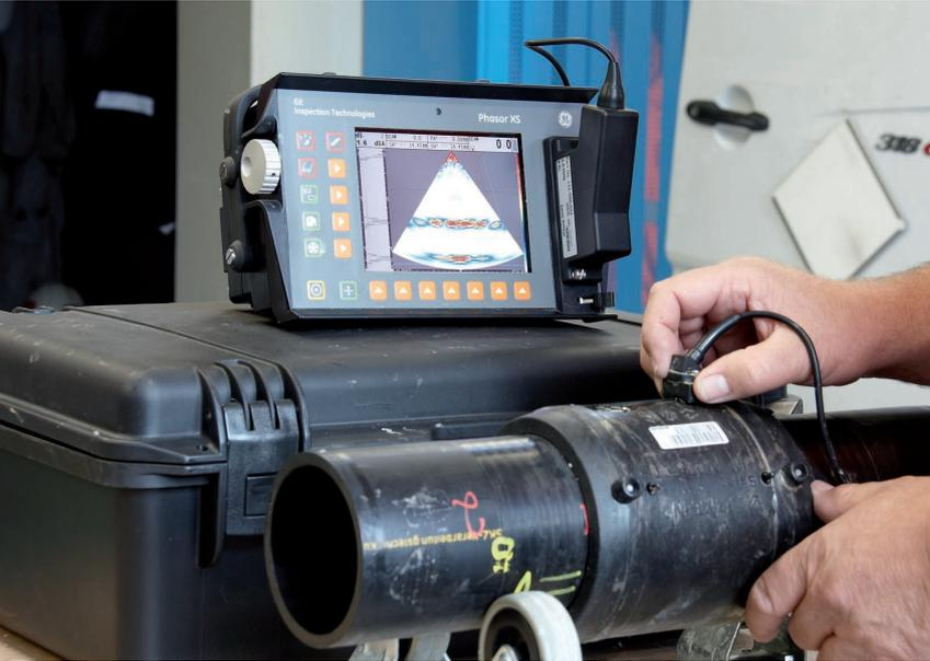
Phased Array Prüfung an PE Muffenverbindungen
